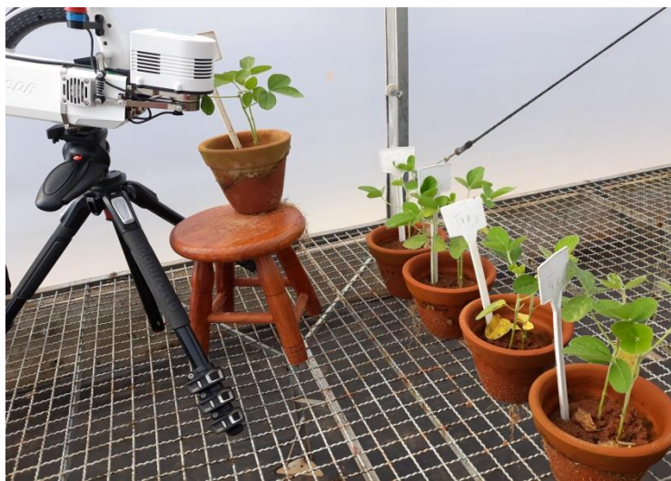
Figura 1. Avaliação com equipamento com sistema aberto de fotossíntese com analisador de \text{CO}_2 e vapor d'água por radiação infravermelha (“Infra Red Gas Analyser – IRGA”).
